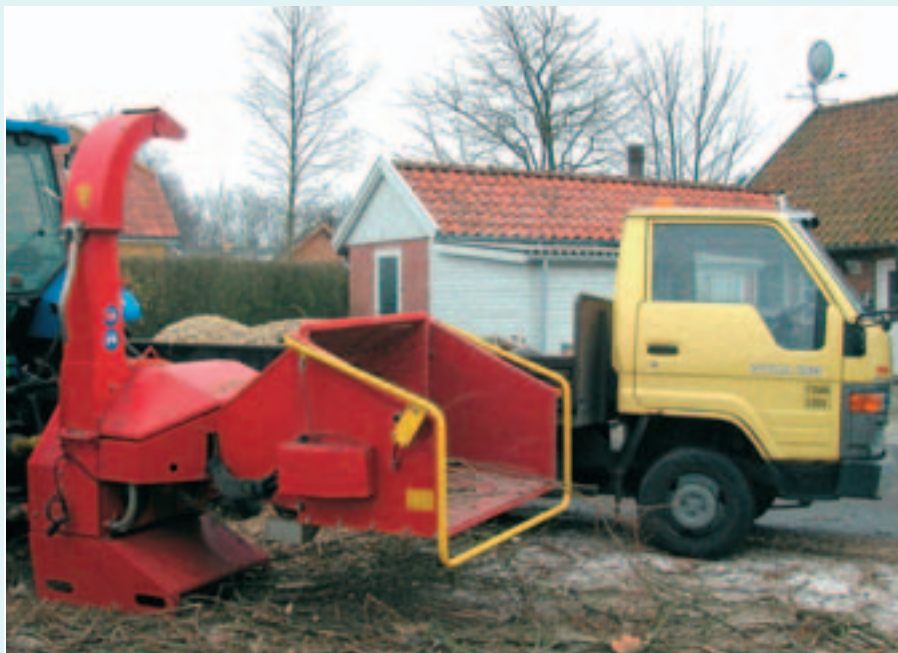
Figur 4. Ved mindre flismaskiner uden kabine kan man prøve at planlægge arbejdet så man ikke indånder ret mange sporer. Kan det ikke lade sig gøre, må man bruge en P3-maske.
