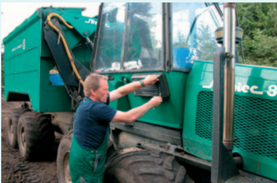
Figur 2. Filtersystemet skal kontrolleres og vedligeholdes for at yde tilstrækkelig beskyttelse. Filteret skal være af F7-kvalitet.
